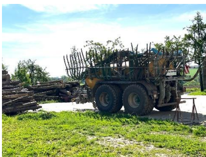
Figure 4: Bodennahe gülleausbringung erfolgt bei uns schon seit jahren, um die Emissionen noch geringer zu halten muss die gülle nun binnen 4 stunden eingearbeitet werden, für uns nicht das riesen problem, da wir genug arbeits- und schlagkraft, aber für viele Landwirte die alleine am Betrieb arbeiten schon, per satelliten fotos kann das von der AMA überprüft und auch sanktioniert werden
